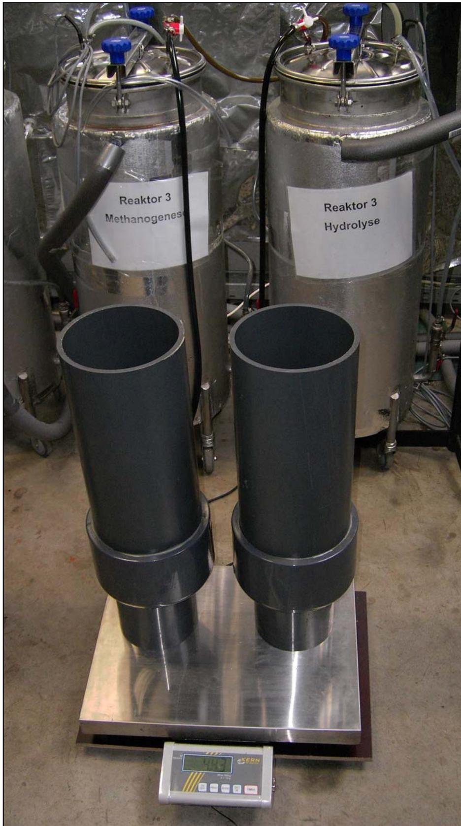
Abbildung 3: Fermenterpaar mit Zwischenspeichern der diskontinuierlichen zweiphasigen Biogasanlage
