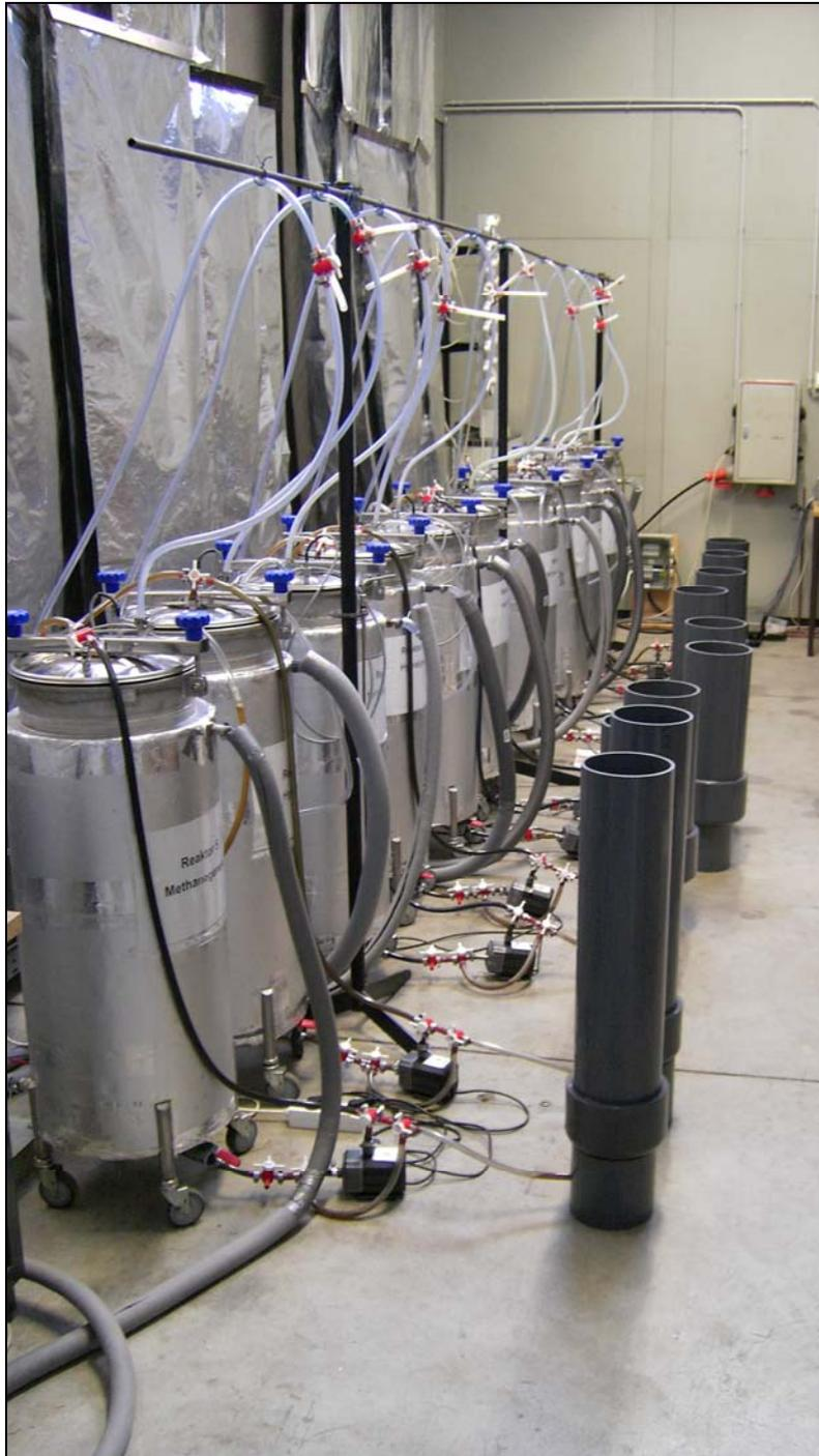
*Abbildung 2: Der Versuchsaufbau I der diskontinuierlichen zweiphasigen Biogasanlage im Feststofffermentationslabor der Universität Hohenheim*
