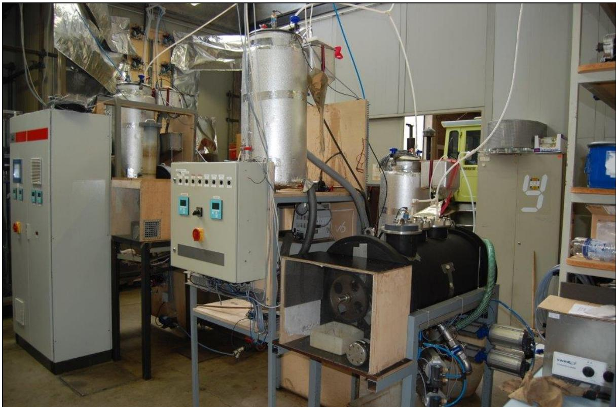
Abbildung 4: Die Versuchsbioanlagen FABES-Modul mit interner Fest- / Flüssig-Trennung (im Vordergrund) und FABES-Modul mit externer Fest- / Flüssig-Trennung (im Hintergrund)
