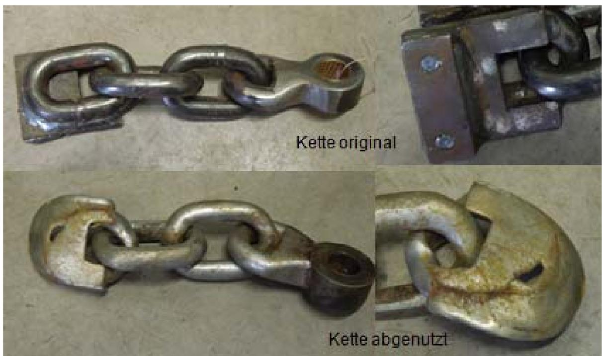
Abbildung 11: Vergleich der Aufbereitungswerkzeuge im unbenutzten und verschlissenen Zustand.
