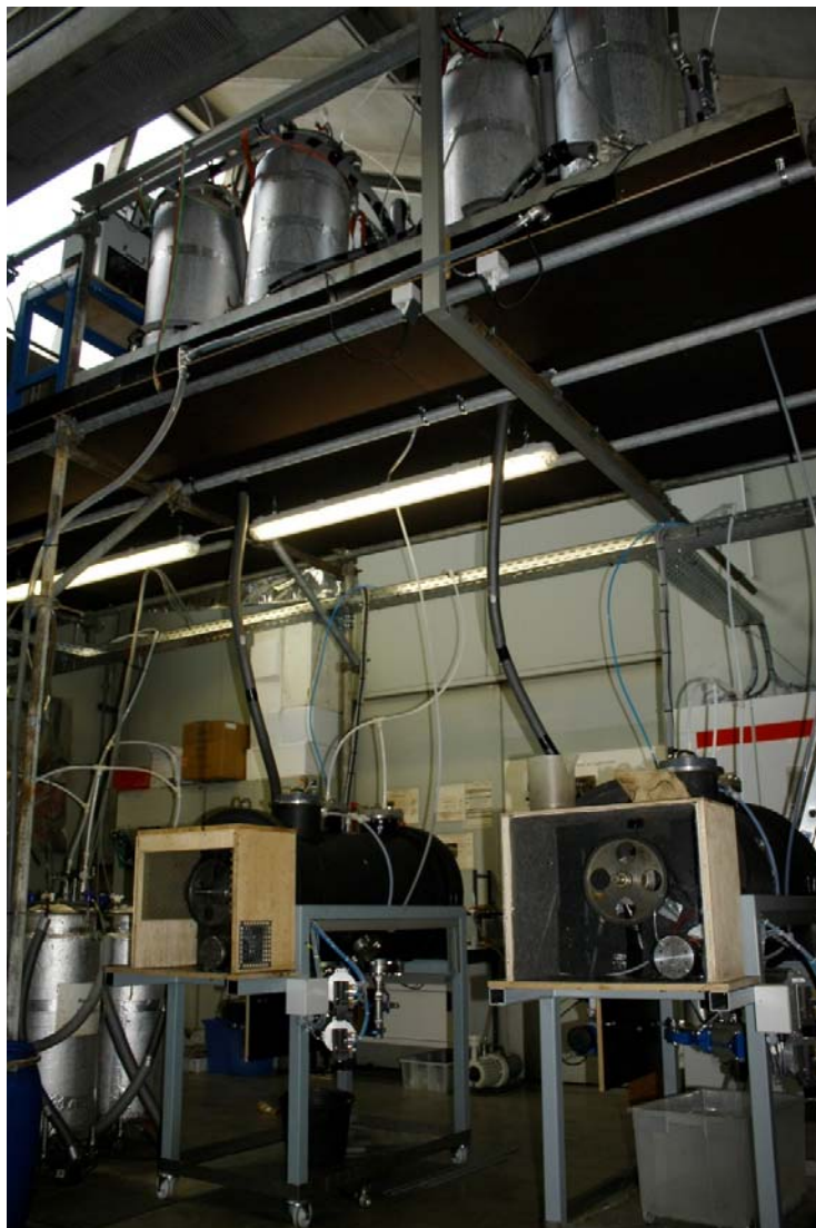
Abbildung 1: Aufbau der zwei Versuchsanlagen mit Hydrolysefermentern und den Methanreaktoren
