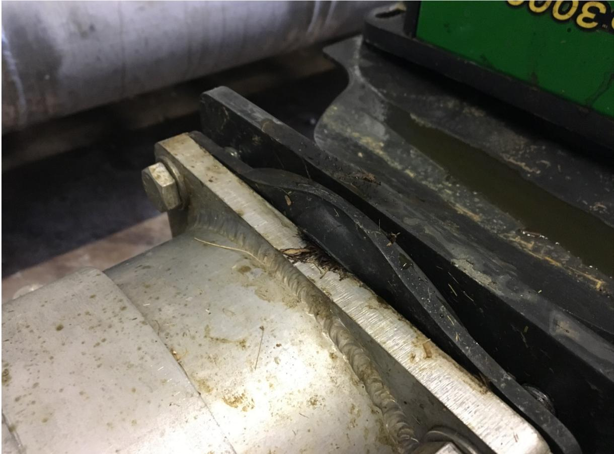
**Abbildung 18:** Dichtung zwischen Pumpstation und des Sensorrohr
