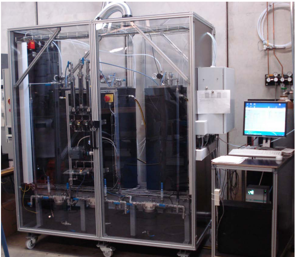
Abbildung 4: Labor- Versuchsanlage zur fermentativen Hochdruckmethanisierung
