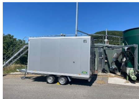
Messung der Gaskomponenten direkt an Fermenter mit neuer Sensortechnik. Rechts ist das installierte UV-Spektrometer zu sehen.
