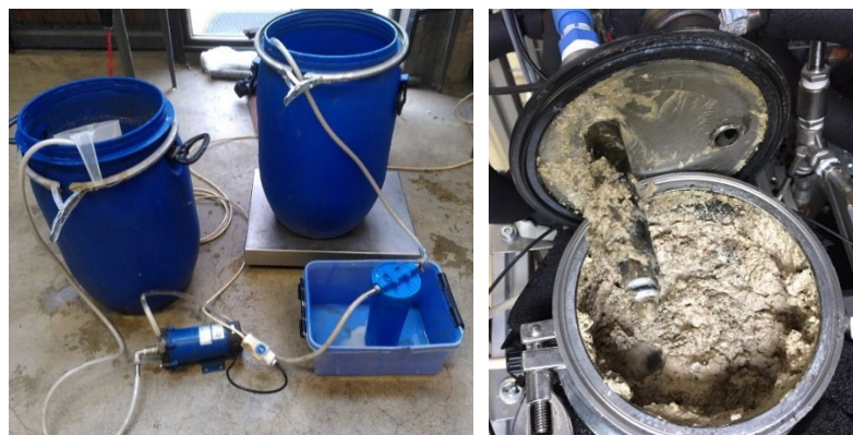
Substratvorbereitung, d.h. Filtration des Molkereiabwassers (links) und Ablagerung unabgebauter Substanzen auf der Flüssigkeitsoberfläche des Reaktors (rechts)
