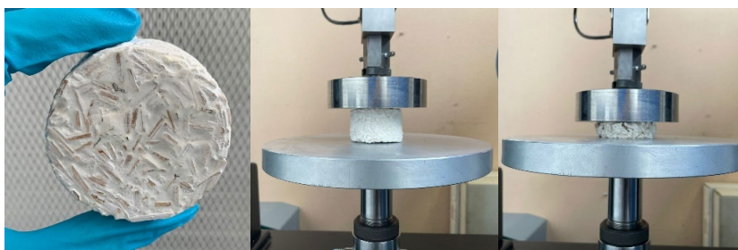
Komposit aus Hanfschäben und Pilzmyzel (links), Druckprüfung der Materialien zur Evaluierung ihrer mechanischen Eigenschaften (Mitte und rechts).
