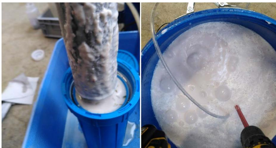
Substratvorbereitung: Filtration (links) und Mischung (rechts) des Molkereiabwassers
