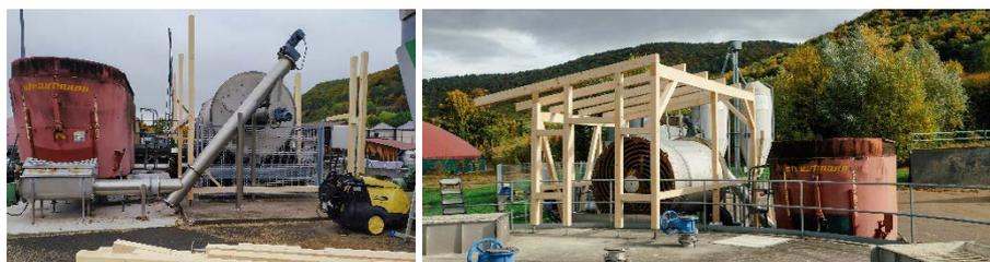
Aufbau und Einbindung des Kugelmühlen-Prototypen an der Forschungsbiogasanlage „Unterer Lindenhof“
