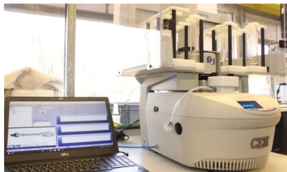
Das neue Gerät zum Mikrowellenaufschluss der Proben zur Bestimmung im ICP-MS
