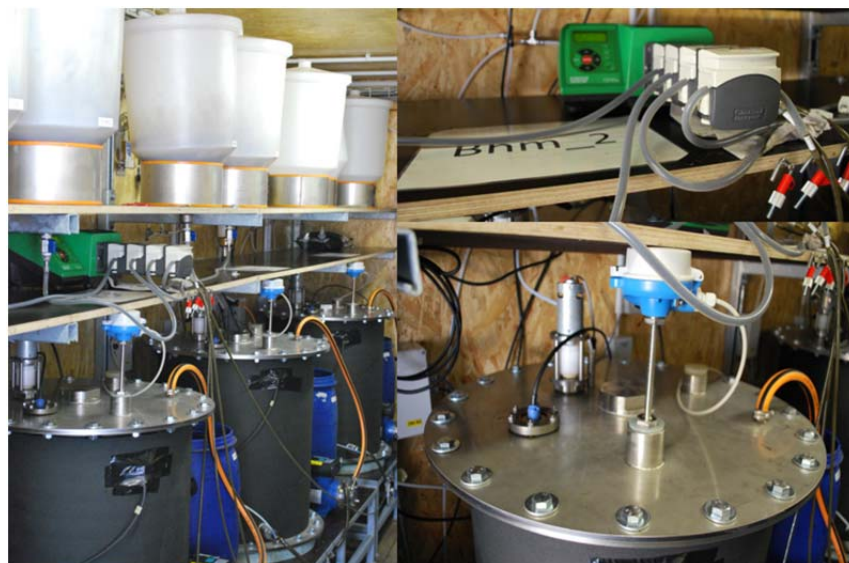
Festbettreaktoren mit Fütterungspumpe zur biologischen Methanisierung
