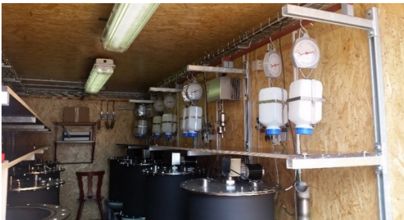
Containerlabor für Versuche zur Methanisierung von Wasserstoff (Lecker, 2016)
