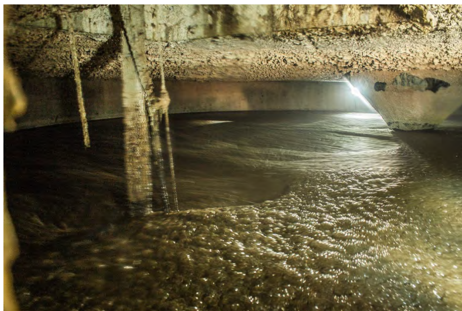
Durchmischungsversuche an der Praxisbiogasanlage der Universität Hohenheim zur Beurteilung verschiedener Rührwerke (Ohnmacht, 2018)
