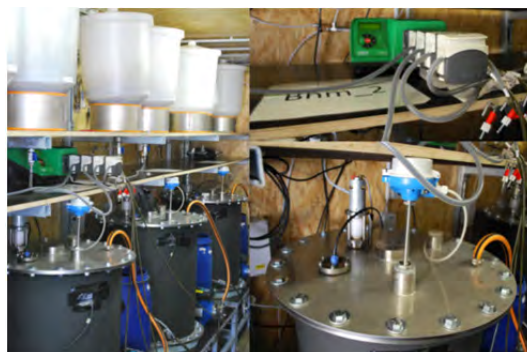
Festbettreaktoren mit Fütterungspumpe zur biologischen Methanisierung (Illl, 2017)
