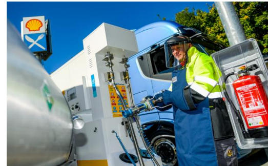
Refuelling for LNG
