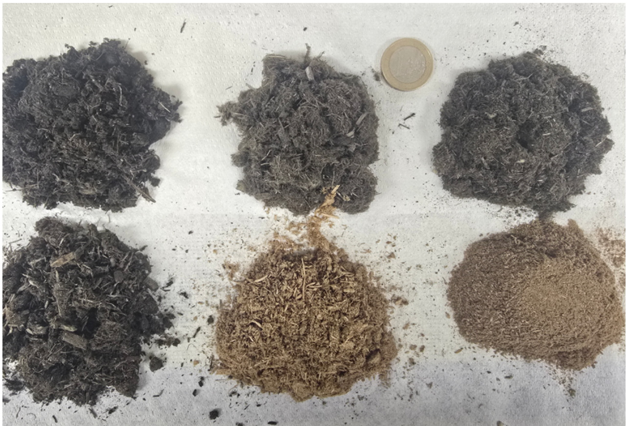
Abbildung 55: Von oben links im Uhrzeigersinn: Rohstoff, feucht; Siebüberlauf, feingesiebt, Rohstoff trocken, Rohstoff gebleicht, Rohstoff gebleicht, gemahlen
