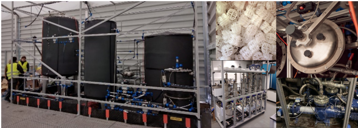
Abbildung 51: Linkes Bild: Biogasanlage mit Hydrolysereaktor (links), Festbettreaktor (Mitte) und zwei Vorlage-tanks (rechts); Mitte: Füllkörper und Feststofflaborfermenter; Rechts: Filtrationseinheit und Pumpen
